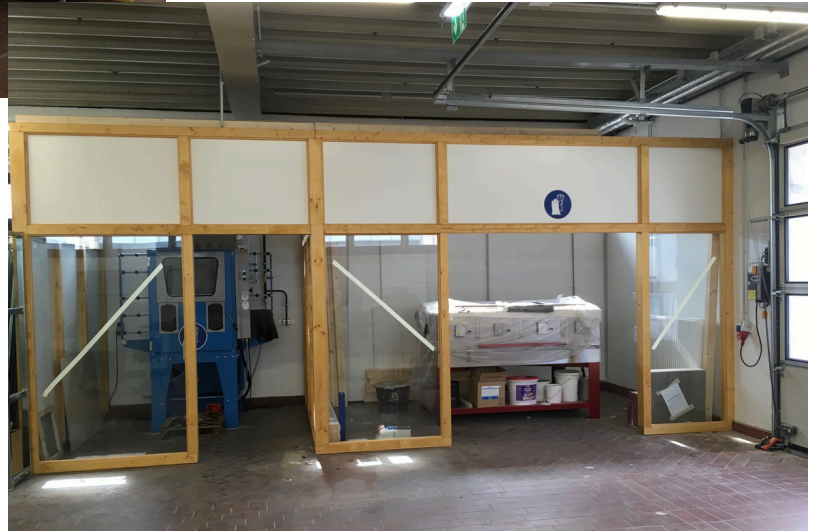
Sandstrahlanlage, Fusingofen, räumlich getrennt aber doch transparent
